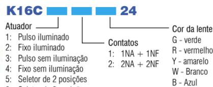
Utiliza lâmpada tipo BA9S incandescente c/ 6.3V, 12V ou 24V 110/220V - utiliza trafo / 6.3V
