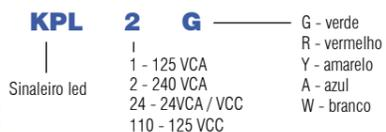
Sinaleiro compacto micro chip LED de alto brilho integrado, fabricado para furações de 22 mm. Apresenta lente do frontal plana sem guarda, que facilita sua visualização de qualquer ângulo. Para 30 mm utilizar bucha de redução
